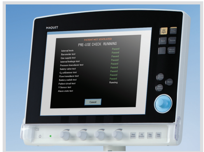
Автоматическая предпроверка аппарата перед работой
